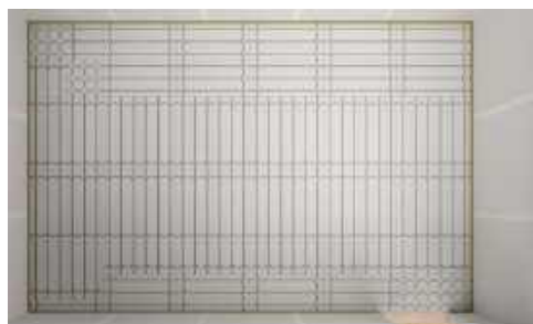
Eksempel på læggeplan med to varmekredse.
