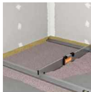
Figur 6 Udjævning imellem dæmningerne (Se 0,55 sek. i montagevideoen.)
