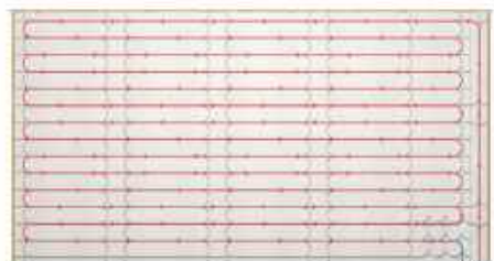
Montage af varmerørene (16 mm).
